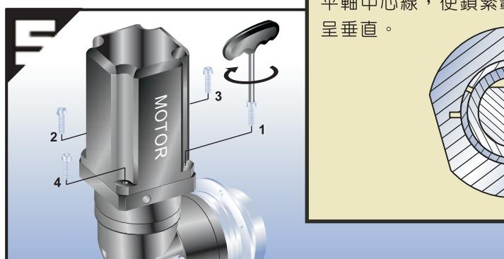
直立式的裝入馬達，以螺絲扭力表（表一）建議扭力值之 5%，依 1~4 的順序，用板手將附墊片之螺絲輕輕鎖上。
