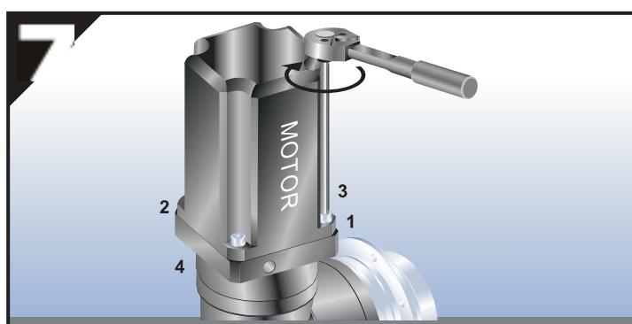
將馬達與減速機直立擺設，以螺絲扭力表（表一）建議之扭力值，依 1~4 的順序，用扭力板手將螺絲鎖緊。
